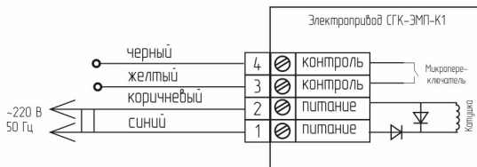
Рис2. Схема соединения СГК-ЭМП-К1
