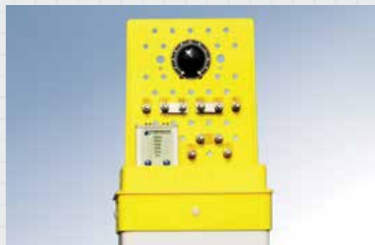
Контроллер МКИ, установленный в КИП
