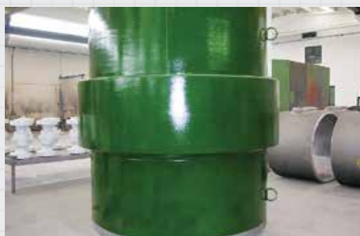
Изолирующая монолитная муфта диаметром 2235 мм на рабочее давление 9,8 МПа
